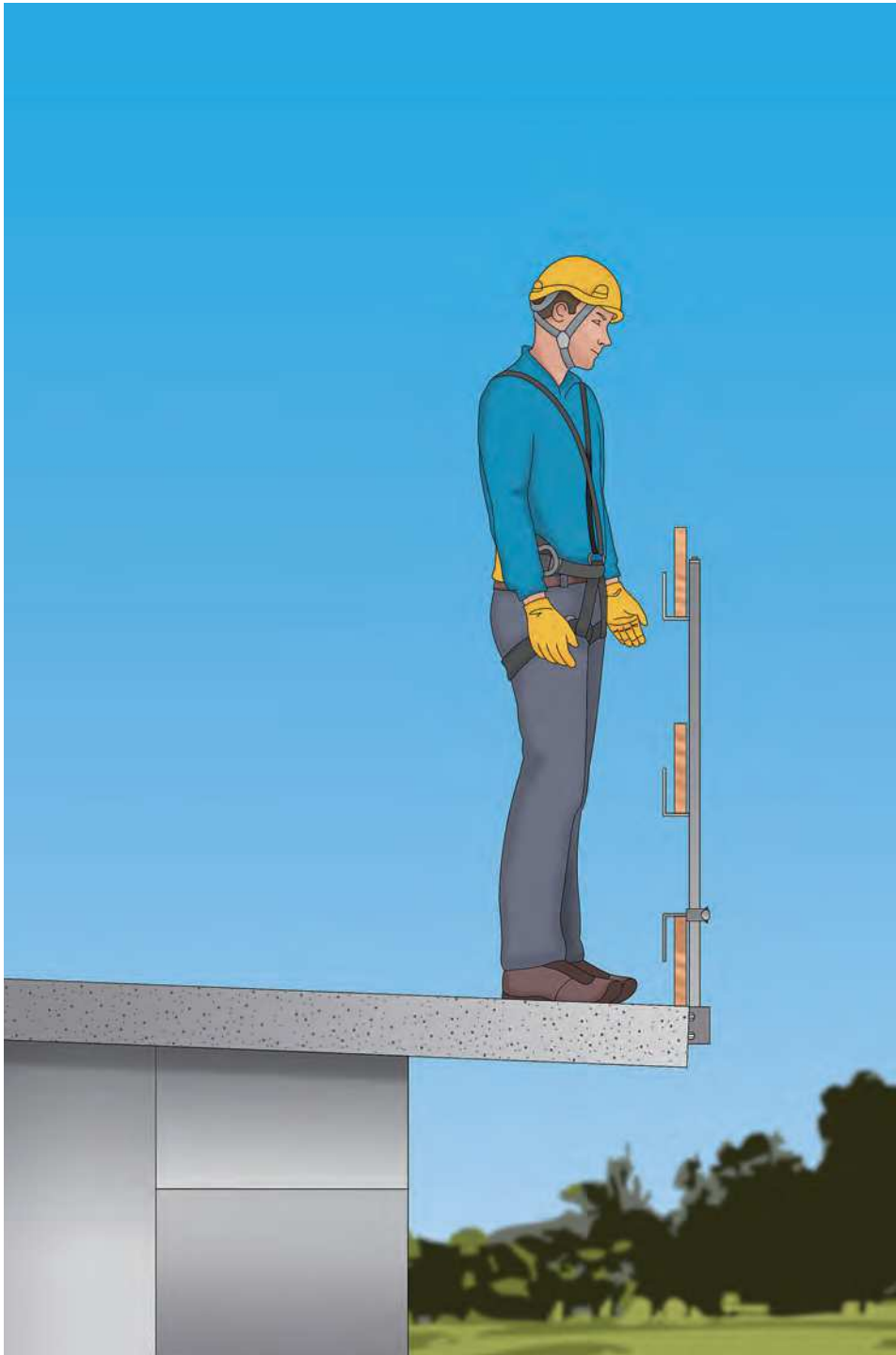
Figura 4 - Parapetti provvisori divisi per classi di utilizzo
