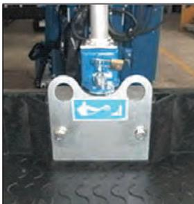
punto di vincolo in quanto è concepito a scopo di sola trattenuta della persona all'interno della piattaforma di lavoro. Il punto di vincolo, secondo quanto prevede l'attuale edizione della norma EN 280 (punto 5.6.14), è dimensionato dal costruttore per una forza di 3 kN e non di 10 kN come previsto per i punti di ancoraggio di dispositivi anticaduta. Tuttavia, **si fa presente che qualora il lavoratore nel cestello utilizzi un sistema di arresto della caduta anziché**
