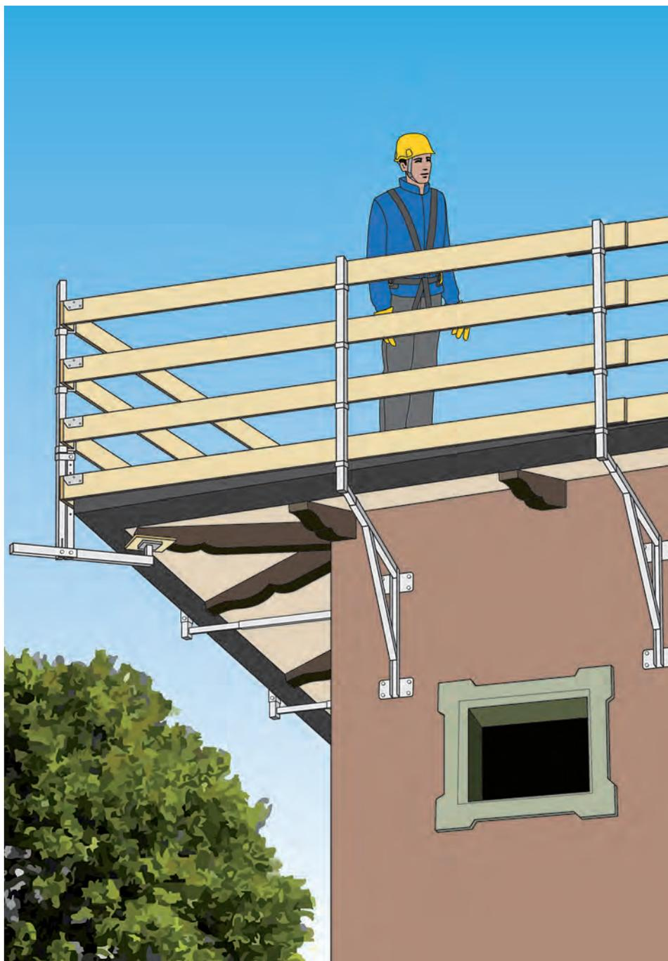
**Figura 6** - Parapetto provvisorio con gancio sottocoppo
