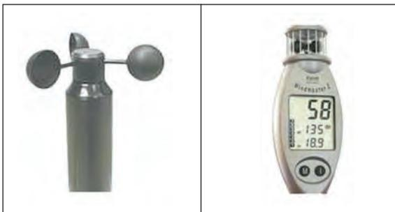
Figura 7 - Esempi di anemometri: fisso e portatile
