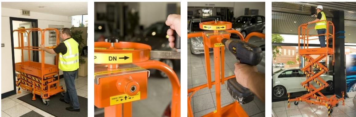
*Esempio di PLE con dimensioni e caratteristiche idonee per attività all'interno e elevazione a mano o con trapano elettrico*
