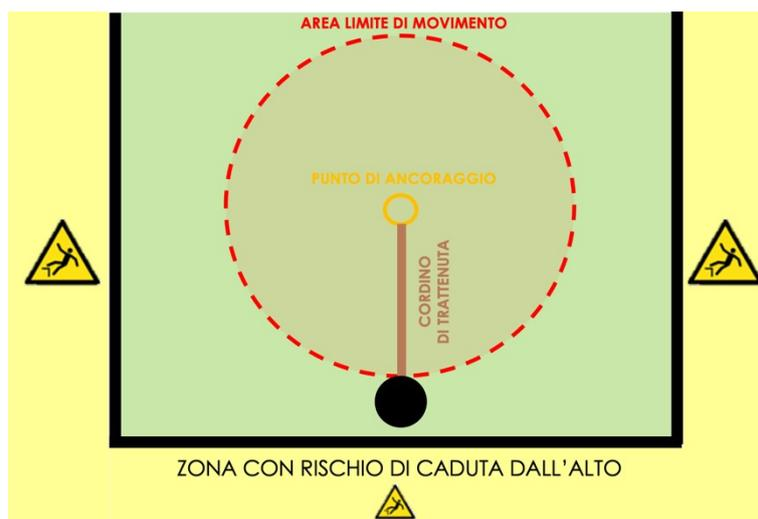
*Esempio di sistema che evita la caduta del lavoratore*
