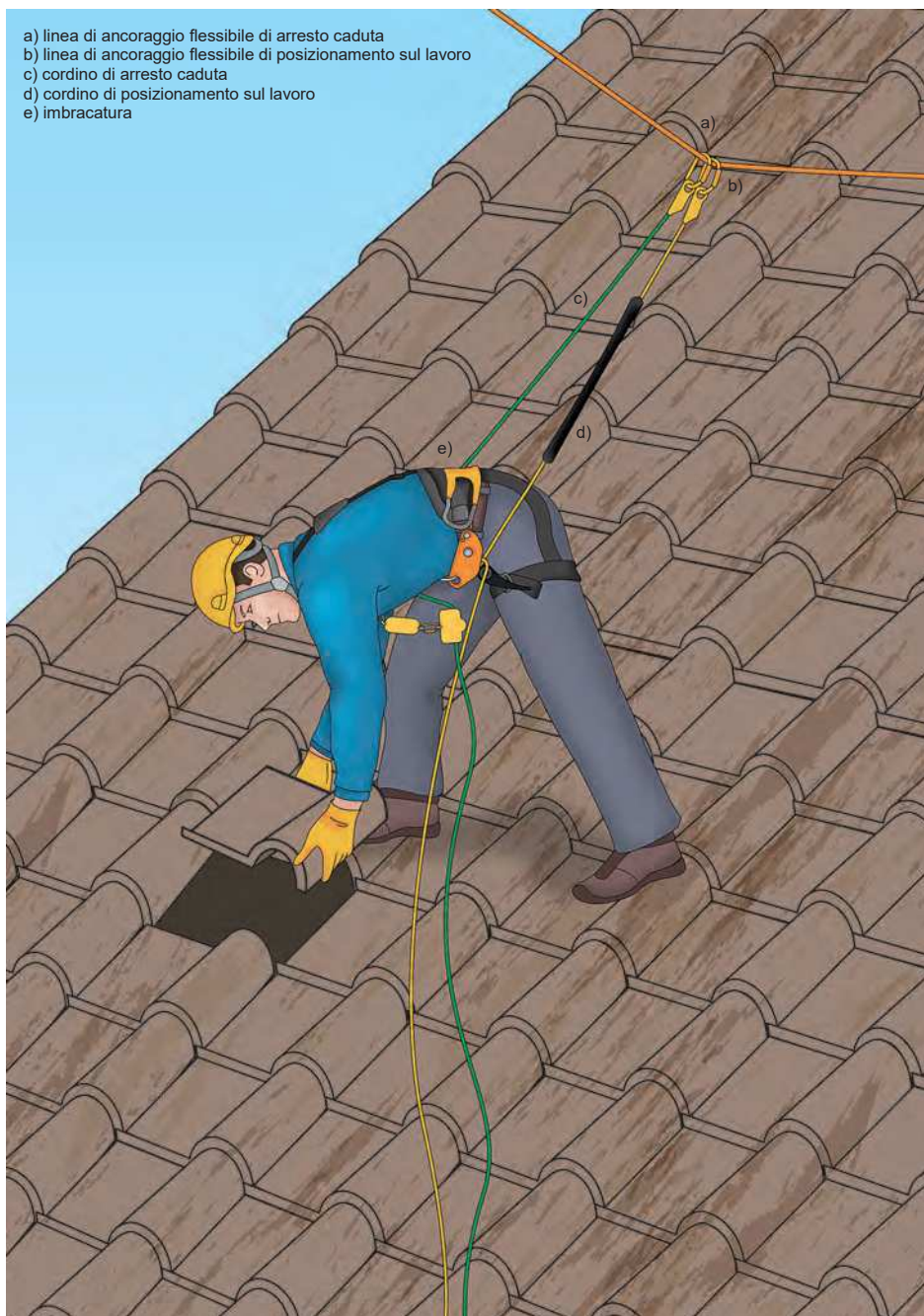
Figura 3 - Esempio di un sistema di posizionamento sul lavoro che include un sistema di arresto caduta
