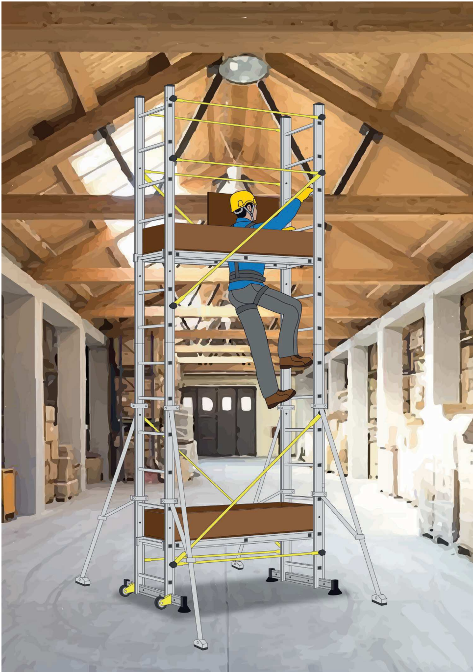
Figura 3 - Piccolo trabattello - Accesso dall'interno
