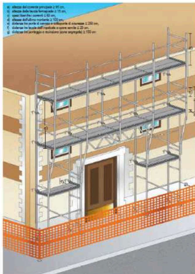
Figura 2 - Principali requisiti dimensionali dei ponteggi fissi non in legno stabilito dal d.lgs. 81/08
