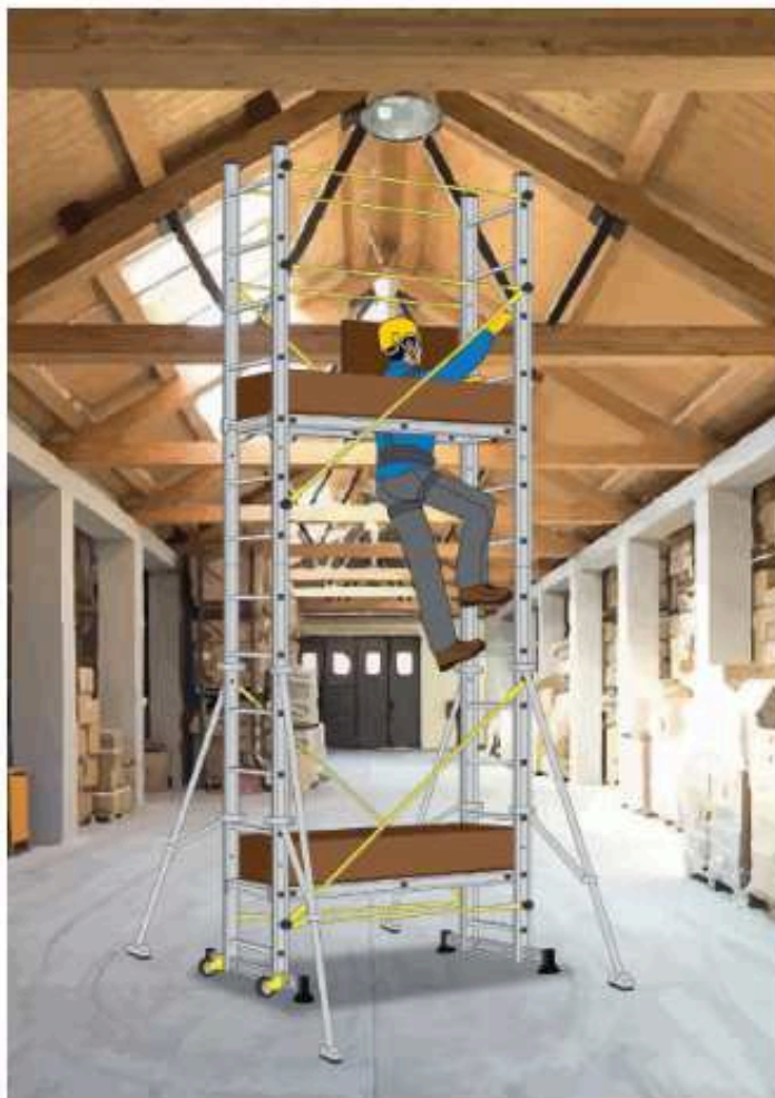
Figura 3 - Piccolo trabattello - Accesso dall'interno
